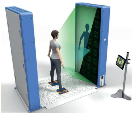
Bild 10: Der Körperscanner R&SR®PS arbeitet im Frequenzbereich von 70 GHz bis 80 GHz mit einer Sendeleistung von 1 mW und jeweils 3008 Sende- und Empfangsantennen. Nacheinander werden einzelne Antennen aktiviert und 128 Frequenzkanäle durchgeschaltet. So beträgt die Scanzzeit für eine Person 32 ms.
