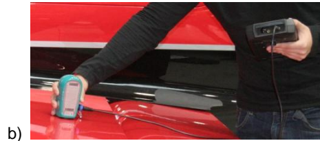
Bild 14: Messgerät FSC zur zerstörungsfreien Messung von Lackdicken auf Carbon Compositen. a) Übersichtsbild b) Detailbild mit Handmodul (grün) und Bedien- und Anzeigemodul (schwarz)
