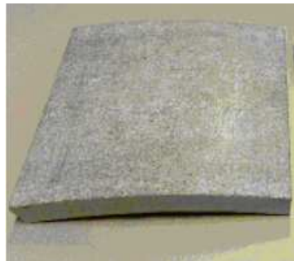
Bild 1: Gewölbte Platte mit Abmessungen 200 mm x 200 mm x 22 mm.
