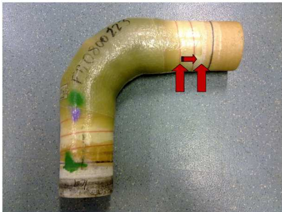
Bild 4: Rohrkrümmer aus GFK mit Sand. Wanddicke etwa 5 mm
