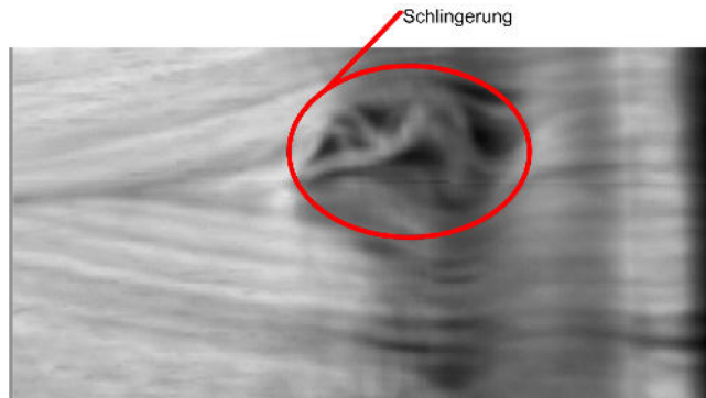
b) Mikrowellenscan von Blattfederabschnitt
