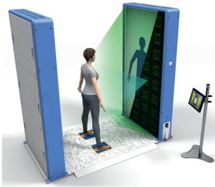
Bild 10: Der Körperscanner R&SR®PS arbeitet im Frequenzbereich von 70 GHz bis 80 GHz mit einer Sendeleistung von 1 mW und jeweils 3008 Sende- und Empfangsantennen. Nacheinander werden einzelne Antennen aktiviert und 128 Frequenzkanäle durchgeschaltet. So beträgt die Scanzeit für eine Person 32 ms.
