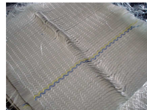
Bild 3: Foto des Prüfobjektes, Glasfaserlage mit Welle nach Druckausgleich und Entfernen der oberen Lagen
